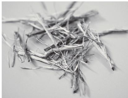
Las fibras sintéticas Synmix® EZ54 están fabricadas a partir de monofilamentos vírgenes de polipropileno, retorcidos hasta formar una cuerda. Las fibras Synmix® están diseñadas específicamente para reforzar aplicaciones de concreto y son resistentes alcalinas, no absorbentes y completamente no corrosivas. Las fibras proporcionan control de grietas, durabilidad, y flexión post
